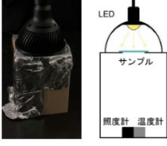
図3.使用した実験装置
